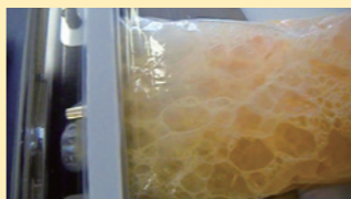
通常真空時: 減圧により突沸し吹きこぼれ
